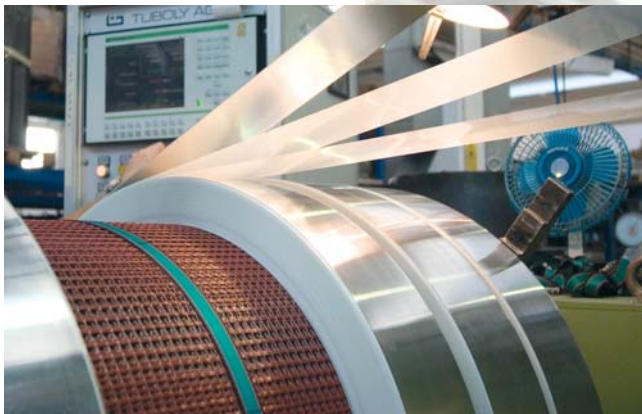
Devanadoras modernas con control electrónico.
